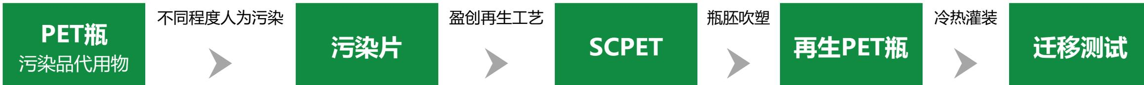
此研究得到的实验数据证明重度污染的PET碎片经我公司深度净化工艺之后可以生产出洁净的再生PET切片。该再生切片制备的PET瓶符合FDA要求。即使是不挥发物质，例如苯基环己烷，在冷灌装和热灌装条件下，同样低于FDA的最大迁移限制：10ppb。
