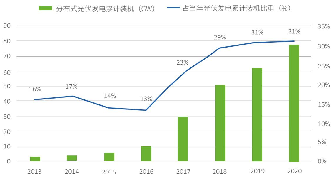
图1 我国分布式光伏发电发展情况（2013-2020年）（数据来源：<sup>[2]</sup><sup>[3]</sup>）
