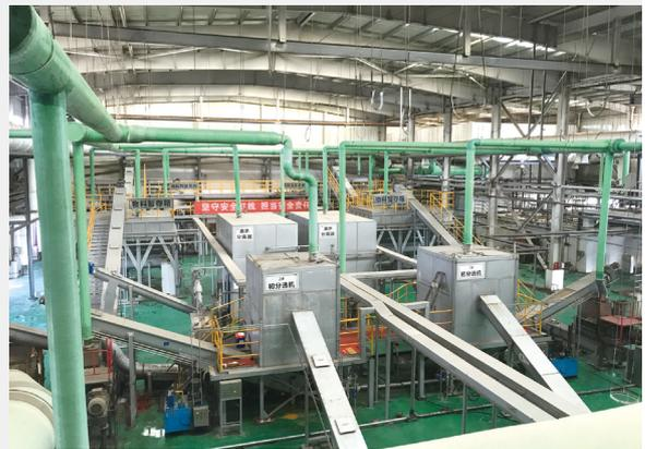
项目已实现稳定运行，餐厨垃圾日收运处理量超过200吨，年产沼气超过600万立方米，计划提纯作为生物天然气，另外油水分离后的粗油脂也是主要产品。餐厨垃圾处理后的沼液计划外运至污水处理厂，沼渣运往园区内垃圾焚烧厂焚烧处理。
