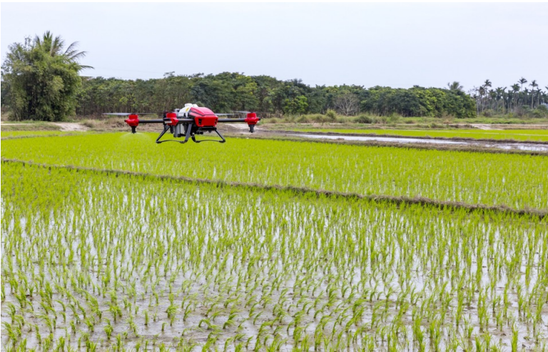
图 1. 水稻田上方作业的植保无人机
